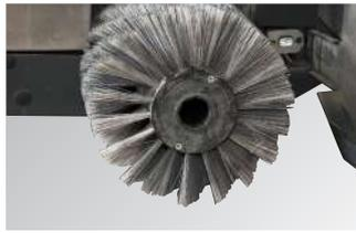
Robusta e grande spazzola centrale d.300 autolivellante a pressione regolabile e rotazione antioraria. Gruppo spazzola in acciaio inox. Innovativo sistema AIR RECOVERY (brevettato): grazie all'aria compressa convogliata davanti alla spazzola, si evita la dispersione laterale della soluzione detergente.
