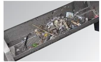
Ampio serbatoio di raccolta in acciaio inox da 30 lt che permette la raccolta dei detriti solidi.
